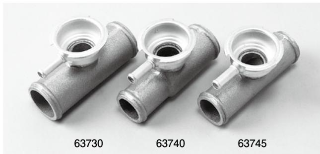
ラジエターのエア抜きが出来にくい車などホースをカットして中間に割り込ませるラジエターキャップベースです。上記キャップとのセットでご使用下さい。
