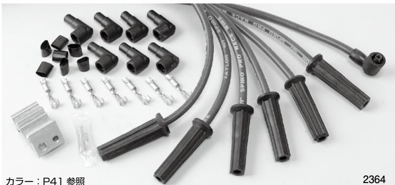
驚異的な外径 10.4 mm のプラグコードです。ニューボルト コイルパワーユニット及び MSD 点火システムはもちろん国産 CDI などすべてに対応します。シリコン、グラスファイバーメッシュなどの 5 層構造で、リーク防止、断熱効果は抜群です。
