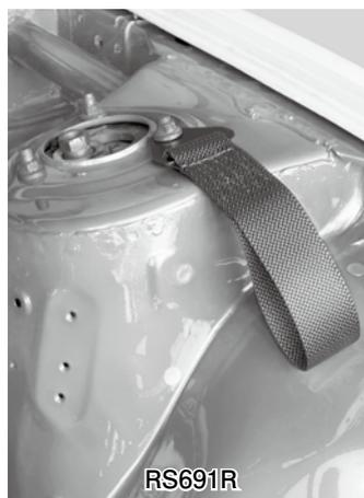
トラブルで車が動かなくなった場合のけん引用フックです。今までは金属製の突起が残り危険でしたが、この製品は布製でソフトタッチですのでボディにキズが付きづらく、歩行者などにも安全です。取り付けは、フロントバンパー廻りで基本的には先端金属プレートの穴とボディ側の穴を利用してボルトで固定します。又、写真でおわかりのようにエンジンルーム内ストラットのナットを利用して固定する事も1つの方法です。
