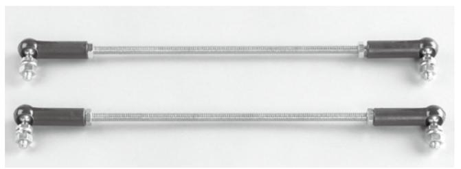
ランプ類などの振動(振れ)防止に…。ボルトは全ネジ状態の為、どこかの位置でもカットが出来、長さを自由に調整する事が出来ます。又、ピロボールタイプですので取り付け角度にもある程度融通がききます。
