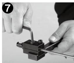
7 次にパイプ止め位置が決まった所で、キャップボルトを付属の六角レンチで本締めして下さい。
