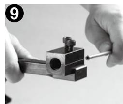
9 次に⑧の作業が完了した所で先程本締めしたキャップボルト2箇所を緩めブレーキパイプを取り出します。
