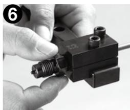
6 次にSTOP刻印のスクリューポンチを最初に使い、手でいっぱい迄(固くなるまで)締め込みます。
