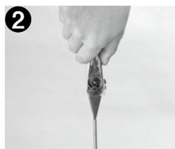
2 次にカットしたパイプの先端内側のバリを丸ヤスリ又はカッター付属の三角ヤスリ部分で取り除いて下さい。
