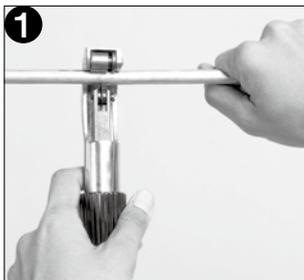
1 まず準備としてパイプをチュービングカッター P358 で必要な長さにかットします。
