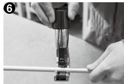
6 後は、下記のチューブ専用カッターなどを用いて必要な長さにカットして下さい。
