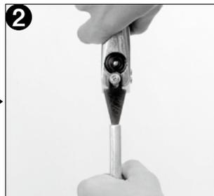
2 次にパイプ先端内側のバリを丸ヤスリ又はチュービングカッター付属の三角ヤスリで取り除きます。
