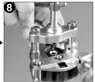
8 次に出来上がった所で一文字ハンドルを廻し (緩め) ネジ部を上まで引き上げ、先程締め込んだ三角蝶ネジハンドルを緩め横にスライドスライドさせます。
