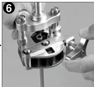
6 次にパイプがストップ位置で止まっているのを確認し、本体横の三角蝶ネジハンドルをスライドさせ締め込みます。
