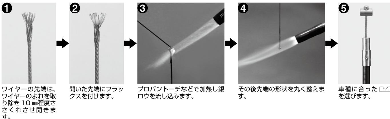
①ワイヤーの先端は、ワイヤーのよれを取り除き 10 mm 程度ささくれさせ開きます。
