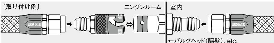
※両端 (ANオス側) に接続するホースラインの製作 (AN3~AN6) をカシメ (圧着成形) で製作も出来ます。(P98、P102 を参照して下さい) 又、全長及びホースエンドの角度などはご相談下さい。
