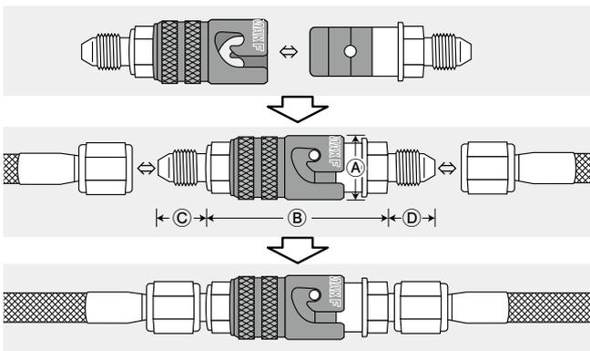
接続をする前に、接触面に汚れなどないかを確認してください。異物・汚れなどの付着により漏れや破損の原因になります。
