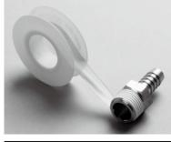
ガソリン対応品です。 ちなみにホームセンターなどで販売しているテープの多くは水専用品ですので使用不可>>確認して下さい。NPT&PT(テーパーネジ)部分には、漏れ防止及びゆるみ防止の為、必ず使用して下さい。
