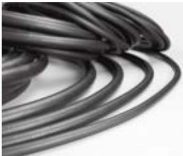
内側のゴム材は、ガソリンはもちろん色々な潤滑油(オイル系)及びクーラント(エチレングリコール)などにも使用可能です。さらに高圧にも耐えられるよう中間にコード(補強糸)を入れ込み、外側には紫外線や熱にも耐えるゴム材を使用した三層構造の高級品です。
