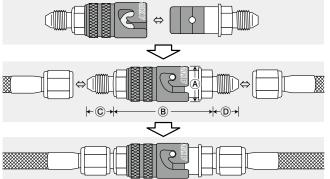
接続をする前に、接触面に汚れなどないかを確認してください。異物・汚れなどの付着により漏れや破損の原因になります。
