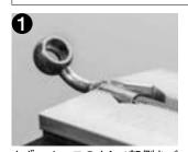
まず、ホースのカシメ部側をバイスなどにセットします。 挟んだ部分が変形しないようにアルミバイスジョー(品番RT1506)で、動かないようにガッチリ固定します。
