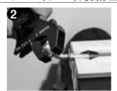
バンジョーをアルミ製モンキーレンチ(品番RTO312K)で挟み、廻して位置を調整します。まだずれている場合は一連の作業を繰り返し行います。注)ワッシャーの当たり面に絶対にキズが入らないよう注意して下さい。
