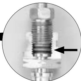
ブレーキパイプ(ホース)のオス、メス接合部が何らかの問題で漏れが発生した場合、メス側に挿入して締め込むだけ(ワンタッチ)です。材質はなじみの良い銅を使用しています。いわゆる緊急お助けマン的シールドです。
