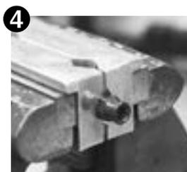
4 次にホースエンドのソケット部分をバイスではさみます。その際、ソケット部にキズ防止の為 P372 のバイスジョー (専用工具) をセットする事をおすすめします。
