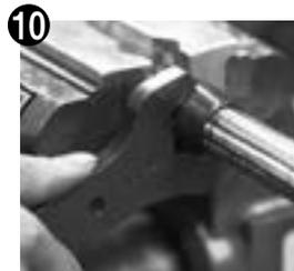
次に本締めですが、キズ・スベリ防止の為アルミホースエンドレンチ（専用工具）の使用をおすすめします。専用レンチは P368、P369 を参考にして下さい。
