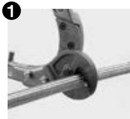
まず P373 のホースカッター（専用工具）などを使用して規定の長さにホースをカットして下さい。
