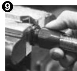
次にソケット部にホースをセットした物とナット・ニップル部分との組み付けですが先にネジ部分同士が噛合うまで手で操作して下さい。
