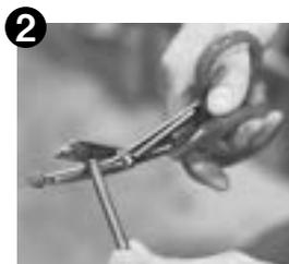
2 次にスピードフレックスホースのステンメッシュ部が内側のテフロンチューブより突き出さないようにステンメッシュ部分を P373 のハサミ (専用工具) などを使用してカットして下さい。
