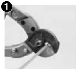
1 まず P373 のホースカッター (専用工具) などを使用して規定の長さにホースをカットして下さい。
