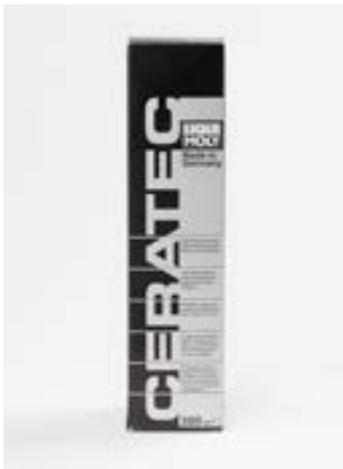
**【概要】** 厳選された六方晶窒化ホウ素 (BN) をベースに構成されたマイクロセラミック固体潤滑剤です。層状のグラファイト類似構造により、摩擦と摩耗が減少し、金属同士の直接接触が抑止されます。<math>0.5\mu\text{m}</math> の粒子サイズにより、最適なフィルターフロー特性が保証され、固体潤滑剤粒子の堆積を防ぎます。
