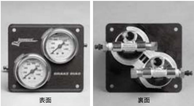
キャリパー交換などをしてプロポーショニングバルブ P311 を取り付けした場合、調整が目安(勘)ではなく車内で圧力を確認する事が出来ます。
