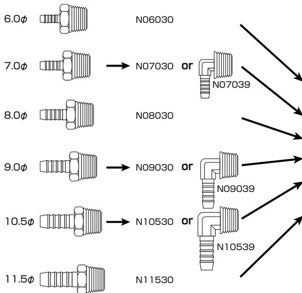
※上記表はマルチシャットオフバルブに取り付け可能なニップル& AN オスアダプターを表示しています。又、色々な組み合わせをする事により異サイズのジョイント(継手)にもなります。ニップル品番の確認はP121、P122を参照して下さい。AN オスアダプター品番の確認はP110を参照して下さい。
