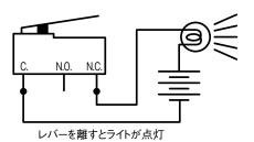
ラインロック(P309)、ナイトロを噴射させる場合のポイントスイッチとして使用。取り付けは、ミッションレバー・サイドブレーキ(ペタル裏)などとの連動で使用します。
