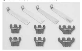
上記の物にプラグコードをタペットカバー上面へもち上げ、ボルトを利用して固定するステーをセットしました。
