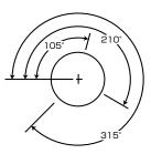
プラグの電極はマイナス端子を背にし燃焼室のインテークバルブ側を向くのが常識です。その角度を変えるシムが3種類(合計30個)入った物をセットにしています。
