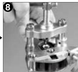
8 次に出来上がった所で一文字ハンドルを廻し (緩め) ネジ部を上まで引き上げ、先程締め込んだ三角蝶ネジハンドルを緩め横にスライドスライドさせます。
