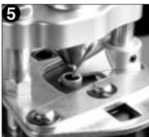
5 次にパイプを本体下から差し込みストップ位置でパイプを止めます。
