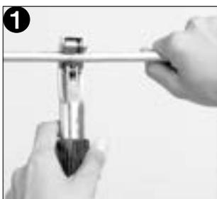
1 まず準備としてパイプをチュービングカッター P364 で必要な長さにかットします。
