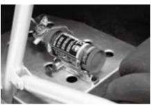
ベース部の固定は平面にボトル&ナット 締めにて。
