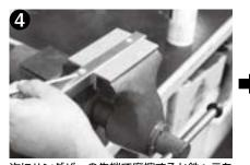
次にハンダバーの先端で摩擦するか鉄へラを 当てハンダバーをこすりつけるかなどして確 実に酸化膜を取り除いて下さい。
