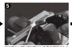
次に母材と同じ様に取付ける側の部品にもハンダバーをすり付け表面にのせます。 それぞれを重ね同時に加熱します。
