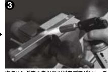
次にハンダする先程の母材をプロバントーチなどで温めて下さい。部材の大きさや厚みなどで温度の伝達具合が異なりますので、その時々でプロバントーチの性能(タイプ)及び火力を選択、調整して下さい。(あまり温めすぎないように)
