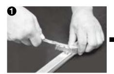
まずハンダの下準備として材料表面のサビ、油分、ペイント(メッキ類含む)などを落としワイヤーブラシや金属タワシなどで表面にキズを付けて下さい。
