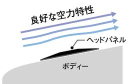
ボンネットや各種パーツをロックするピンで、風圧によるトラブルを防ぐためサーキット走行などでは必要になります。ラン・マックス クイックキャッチ(ヘッドパネル&ピン)キットは空力特性を考慮しつつ、デザイン性と素材感を追求したシンプルなキャッチで、開けたいときはセンターボタンをワンプッシュと操作も簡単。ボンネットなど比較的重いパーツ用のM10、トランクやパネルなど軽量パーツ用のM6の2種類をご用意。ヘッドパネル部はブラックアルマイトとステンレスポリッシュの2種をラインナップ、お車や用途にあわせてお選びください。▶P330 参照
