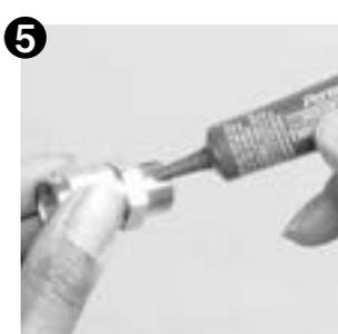
**5** 次に振動の多い箇所や高圧で使用する場合は、構造上ソケット部が緩む恐れがあるのでニップルネジ部に念の為ネジロック(P385参照)の塗布をおすすめします。
