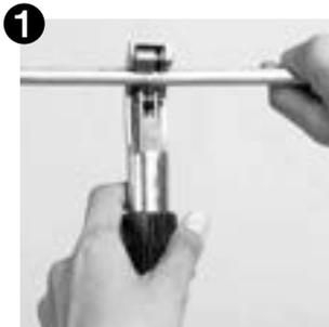
**1** まずアルミパイプを使用する長さに専用カッター P364 品番 RT274 などを用いて垂直にカットして下さい。のこぎり歯使用不可!!
