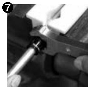
**7** 次に締め付けですが、アルミパイプがニップル部の奥まで差し込まれて(付いて)いるか確認(押す)しながら締め付けを行なって下さい。
